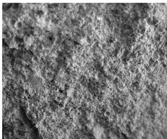
Рисунок 2 – Микроструктура образца плитки с добавками отходов (процент вложения отходов – 10 %)
