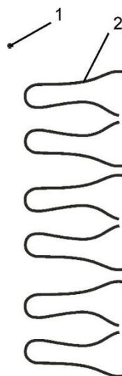
Рисунок 4 – Траектории соединительных строчек
