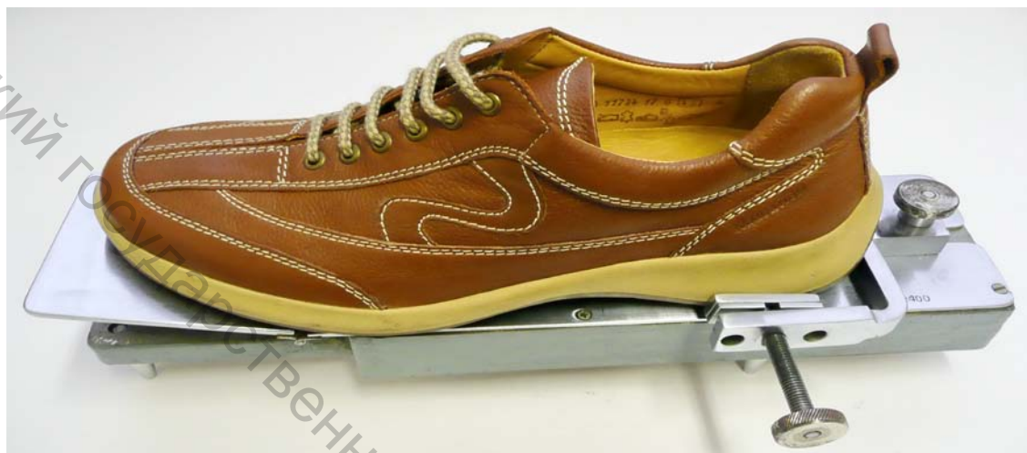
Рисунок 2.6 – Закрепление обуви в приспособлении при испытании подноски обуви
