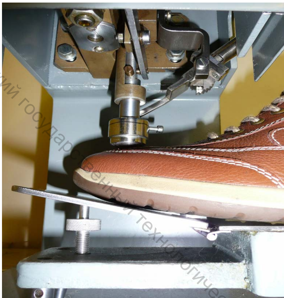
Рисунок 2.7 – Установка приспособления с обувью при испытании подноски обуви
