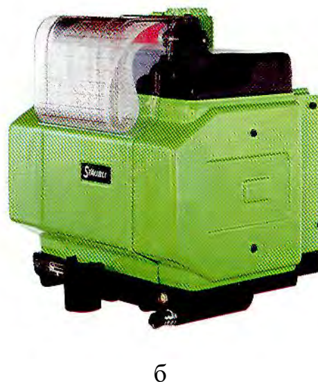
Рисунок 45 – Зевобразовательная каретка СК-12 ткацкого станка АТПР: схема (а) и внешний вид ремизоподъемной каретки фирмы «Штойбли» серии 2200 (б)
