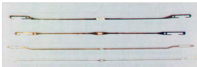
Рисунок 35 – Типы галев: а с витым глазком; б – с впаянным глазком; в – с впаянным цельноформованным глазком; г – пластинчатое
