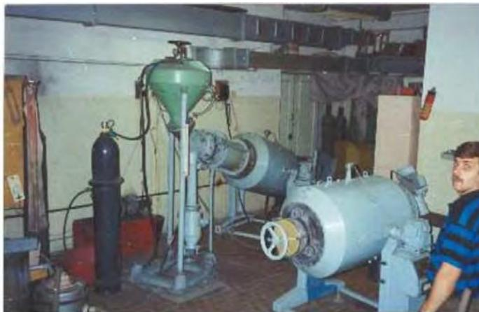
Рис. 2 Установка для термодиффузионного цинкования метизов непрерывного действия
