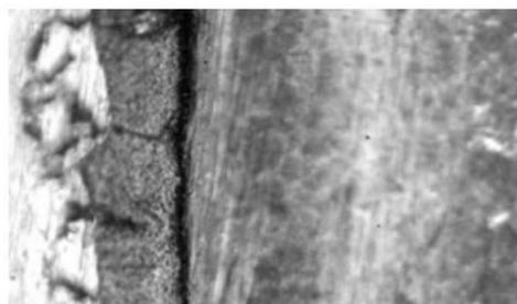
Рисунок 8 – Микроструктура стали 45 после цинкования при 405 °С в течении 150 мин×200
