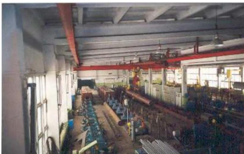
Рисунок 4 – Установка для термодиффузионного цинкования длинномерных изделий (патент РФ № 2156830)
