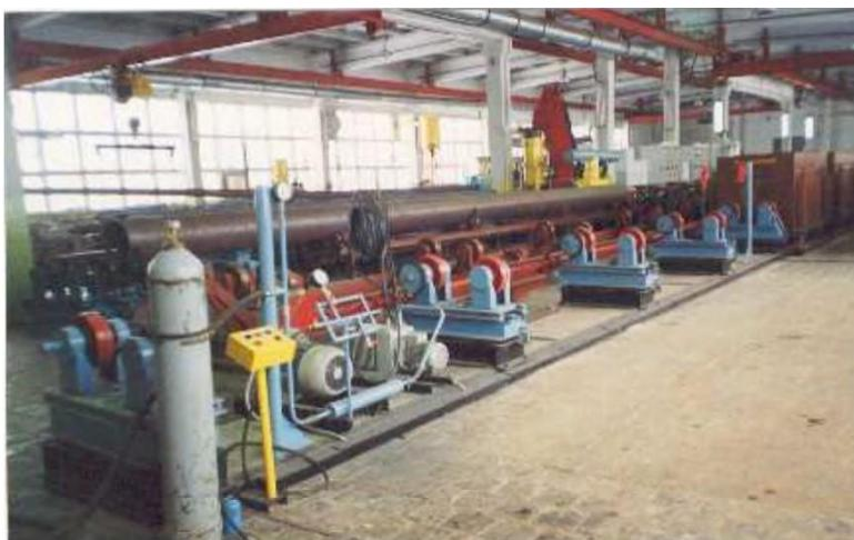
Рисунок 3 – Установка для термодиффузионного цинкования длинномерных изделий (патент РФ № 2156830)
