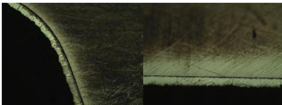
Рисунок 10 – Микроструктура оцинкованного слоя изделий, x100
