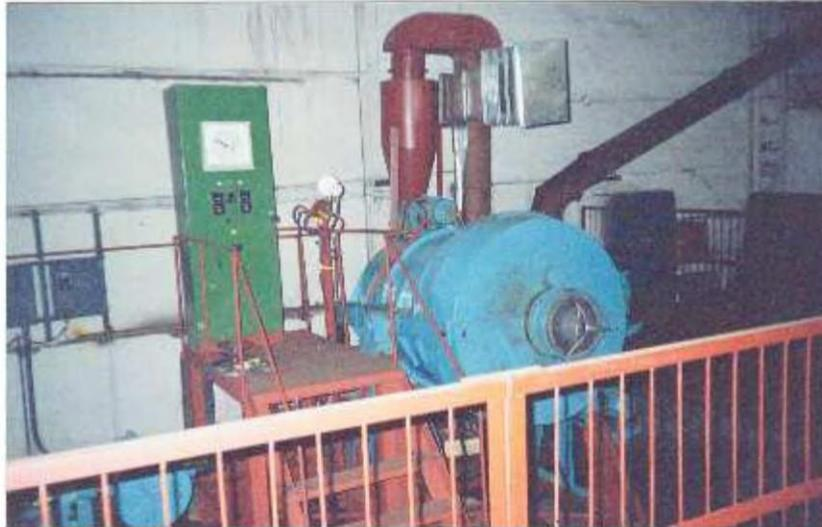
Рисунок 1 – Установка для термодиффузионного цинкования метизов циклического действия
