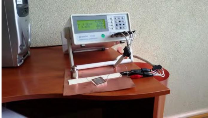
Рисунок 5 – Измеритель иммитанса E7-20 с датчиком
