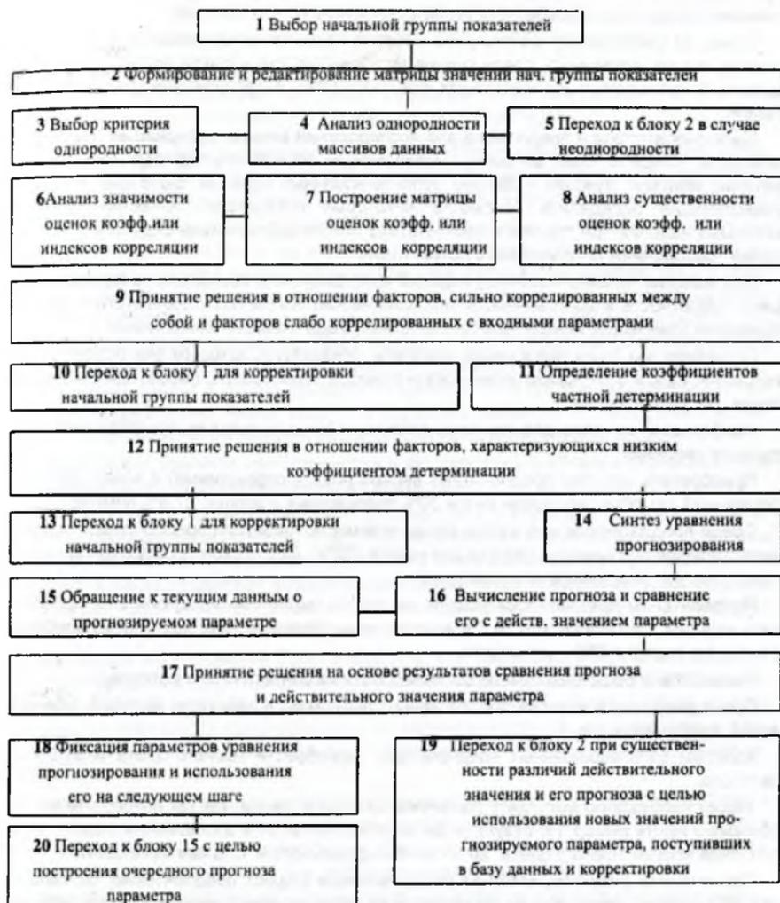
Рисунок 1 — Блок-схема адаптивной модели прогнозирования значений технологических параметров
