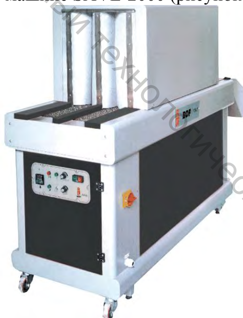
Рисунок А.4 – Машина для влажно-тепловой обработке SAVE-2000 (пр-во Италия)
