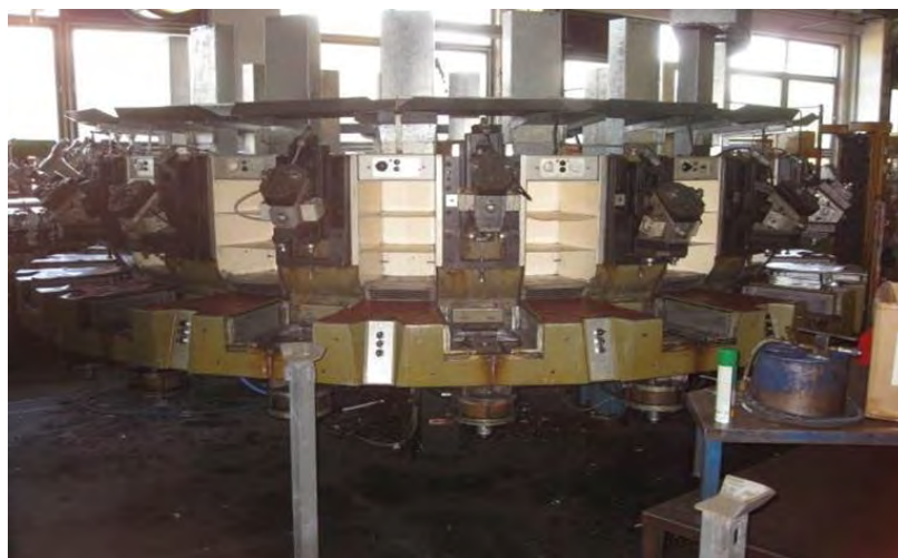
Рисунок А.5 – Литьевого агрегат Десма 581/18 (пр-во Германия)
