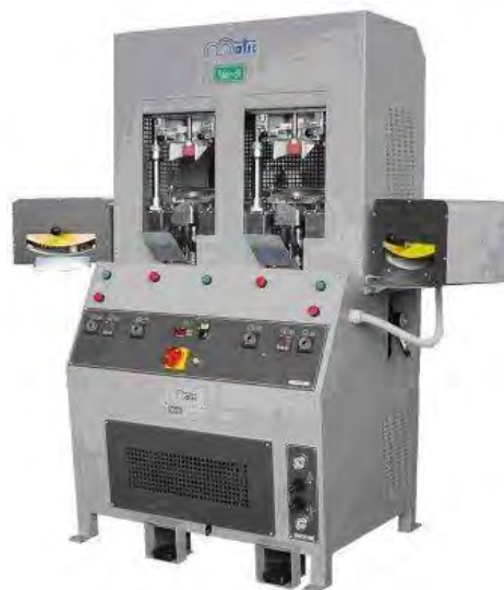
Рисунок А.3 – Машина для формования носочной части MATIC50/2R
