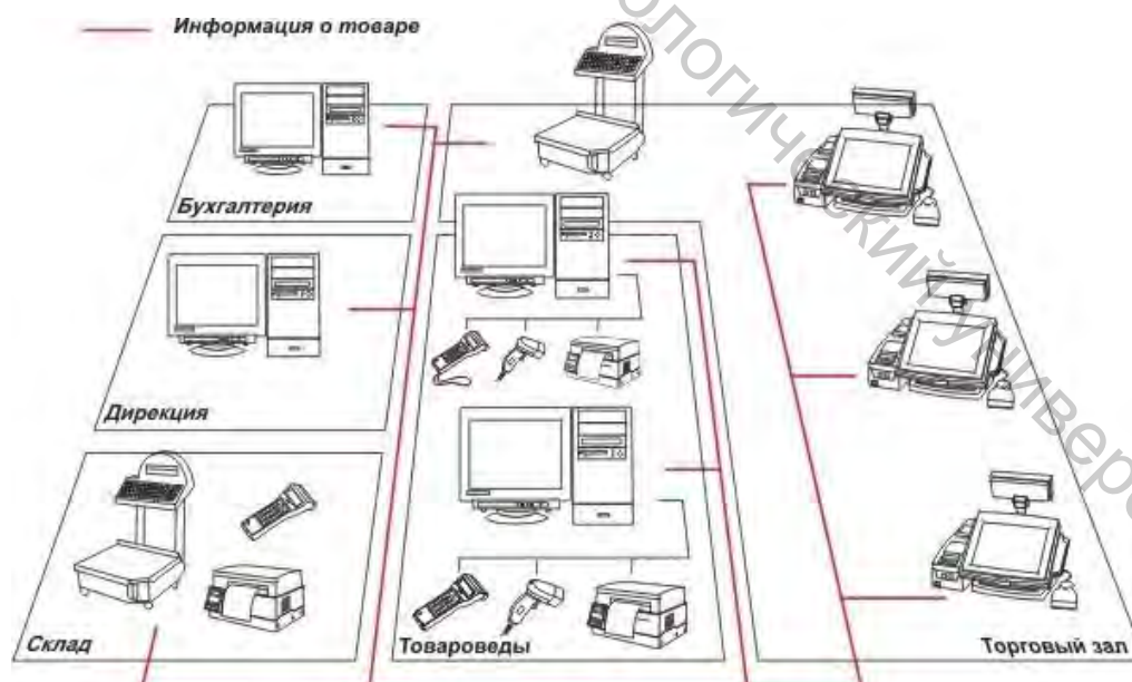
Рисунок 1 – Схема автоматизации торгового процесса:
