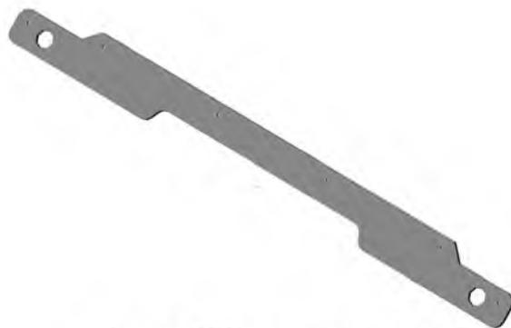
Рисунок 4 – Пластина крепежная
