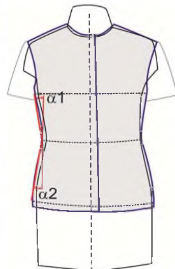
Рисунок 2 – Схема измерения углов наклона фронтального контура одежды
