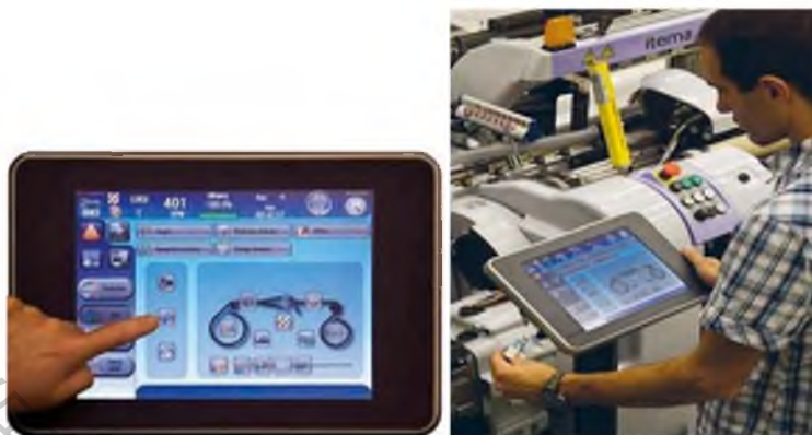
Рисунок 1 – Управление станком сенсорным дисплеем и перенос настроек станка при помощи Memory Stick USB
