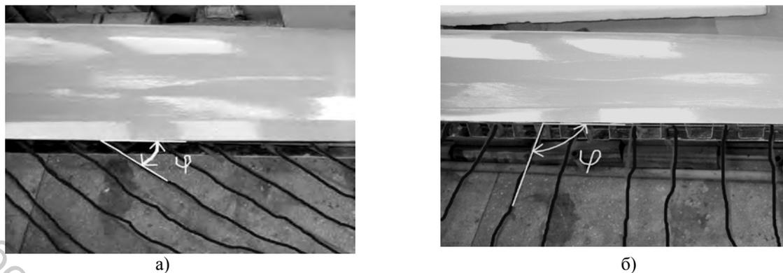
Рисунок 2 – Выход воздуха из воздухораспределителя (вид сверху): а – при свободном истечении из продольной щели; б – через направляющие решетках
