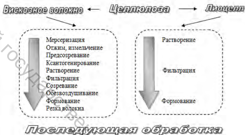
Рисунок 1 – Стадии производства лиоцелла и вискозного волокна
