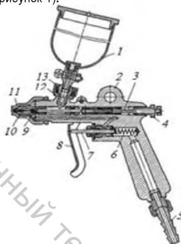
Рисунок 1 – Устройство пневматического распылителя
