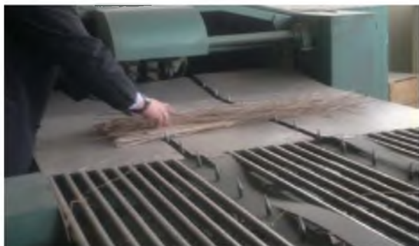
Рисунок 4 – Крапивная треста до и после обработки на станке (треста обработана вдоль)
