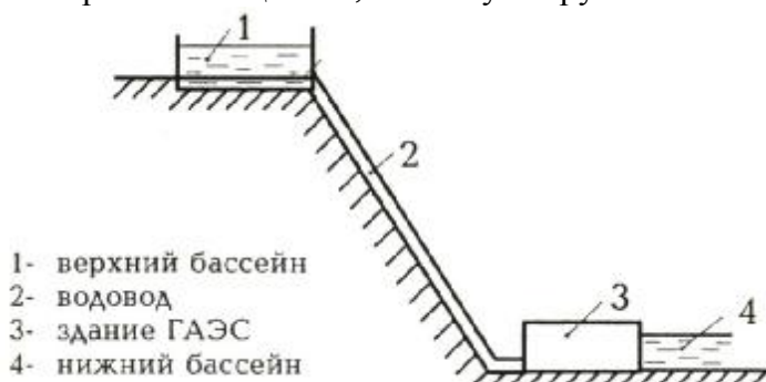
Рис. 2.7. Принципиальная схема ГАЭС.
