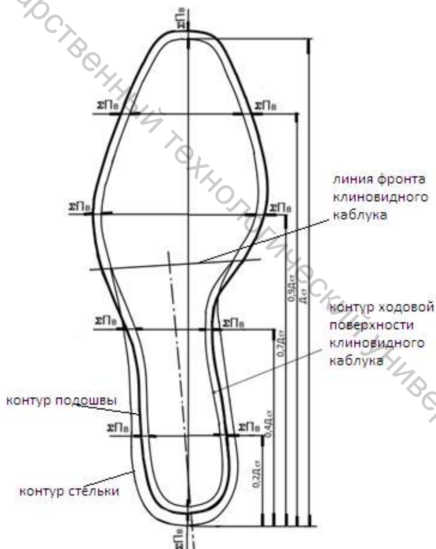
Рисунок 3.12 – Проектирование плоских подошв для обуви на клиновидном каблуке
