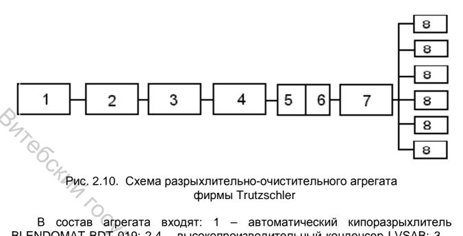
В состав агрегата входят: 1 – автоматический кипоразрыхлитель BLENDOMAT BDT 019; 2,4 - высокопроизводительный конденсер LVSAB; 3 смешивающая машина МХ-U; 5 - смешивающая машина МХ-I; 6- пильчатый разрыхлитель CLEANOMAT CL-C4; 7 - обеспыливающая машина DUSTEX DX, 8 - чесальные машины.
