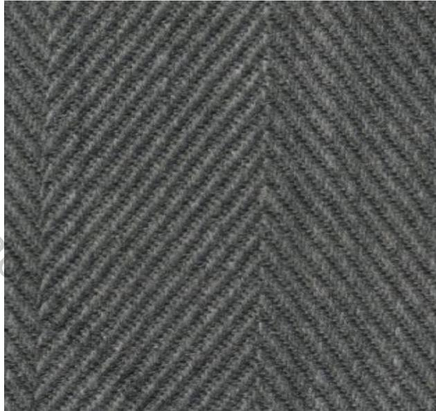
**Рисунок 24 – Ткань, полученная переплетением обратносдвинутая саржа по основе**
