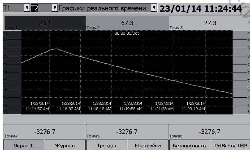
Рисунок 2 – График изменения температуры пластины от времени, полученный во время проведения испытаний
