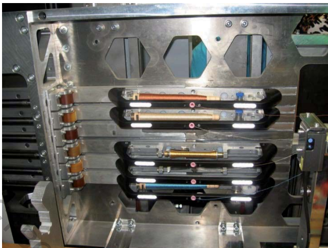
Рисунок 2 – Шестичелночный прибор ткацкого станка
