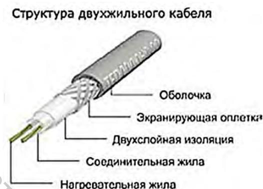
Рисунок 1.1 – Структура двухжильного кабеля
