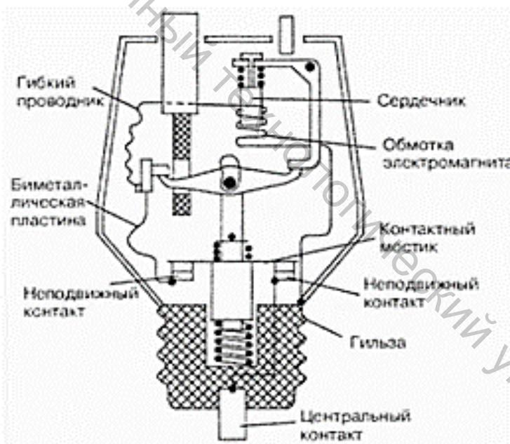
Рисунок 2.3 – Автоматический предохранитель многократного действия
