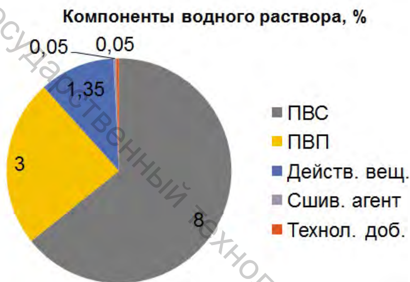
Рисунок 3 – Состав слоя материала
