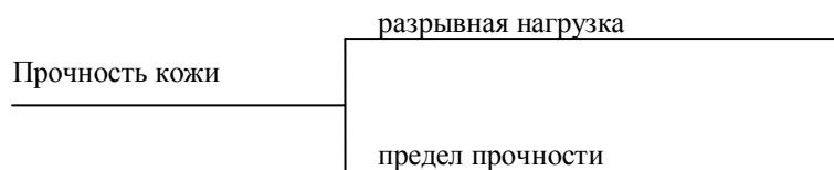
Рисунок 2.7 – Пример невыполнения правила «исключительность»: предел прочности является функцией разрывной нагрузки и толщины
