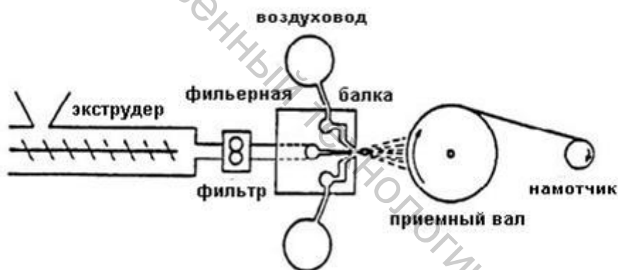
Рисунок 3.9 – Общая схема производства нетканого материала Мелтблаун
