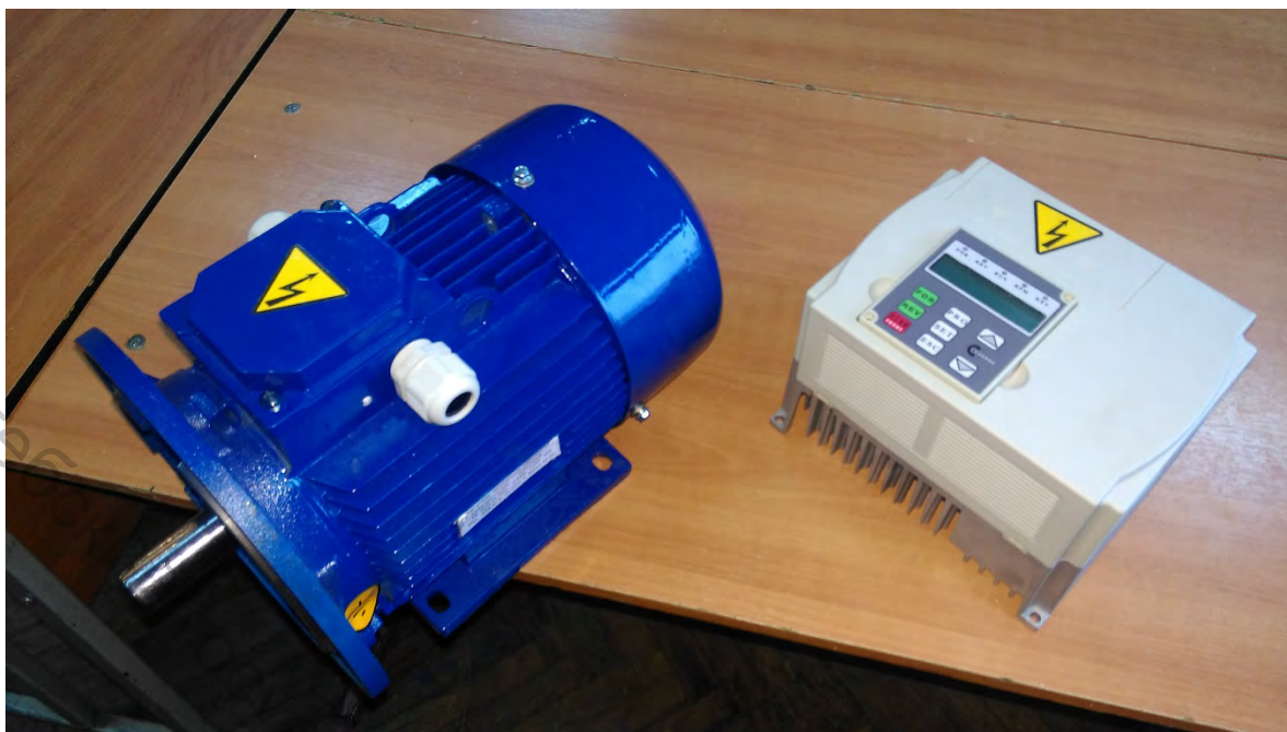
Рисунок 1 – Внешний вид вентильно – индукторного электропривода ВИП-2.5
