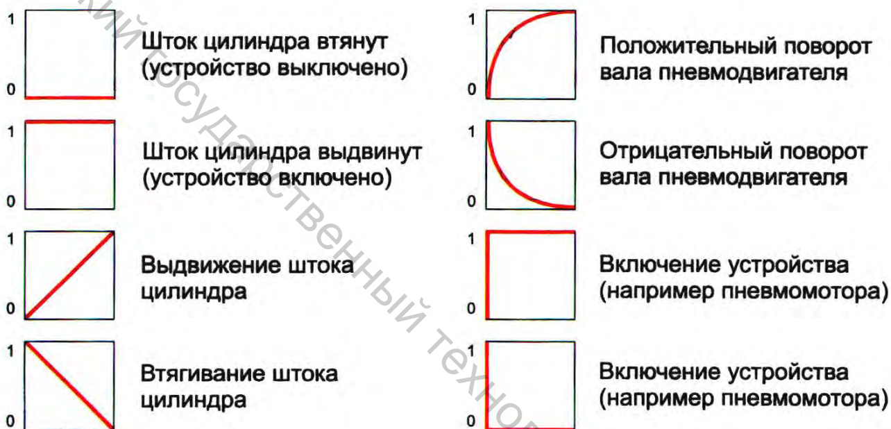
Рисунок 4.2 – Обозначения состояний устройств при диаграммной форме записи
