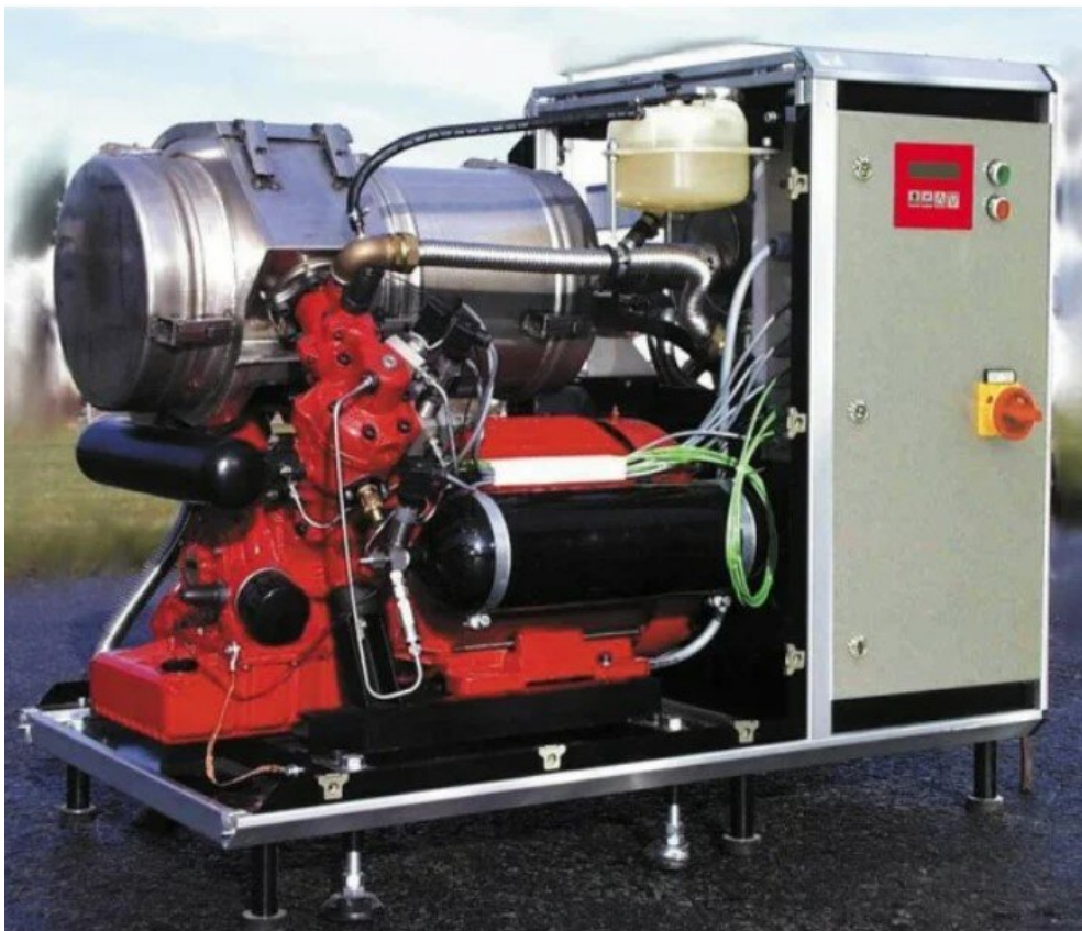
Рисунок 8 – Двигатель Стирлинга, работающий на природном газе мощностью 9 кВт.
