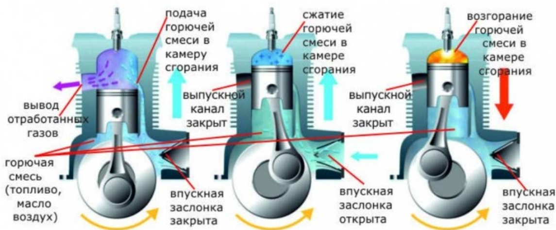
Рисунок 17 – Работа двухтактного двигателя
