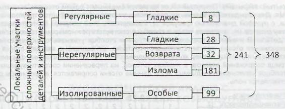
Рисунок 1 – Схема классификации локальных участков поверхностей
