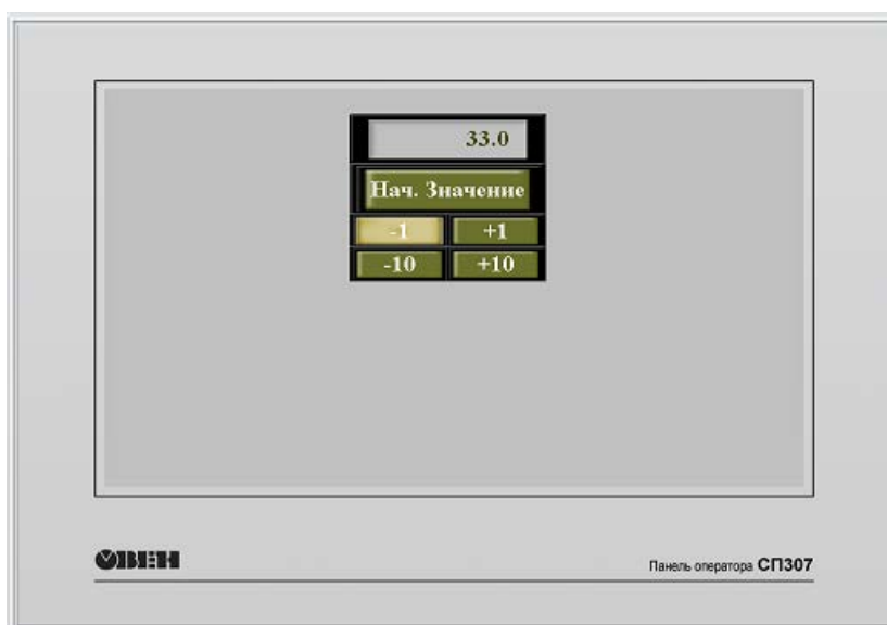
Рисунок 3.19 – Эмуляция работы при изучении принципов работы с численными элементами
