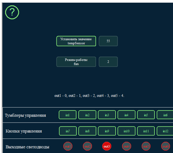
Рисунок 2.43 – Режим работы вентилятора при температуре 55 °С
