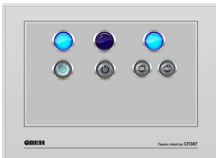
Рисунок 3.15 – Эмуляция работы при изучении принципов работы «Переключатель» и «Индикатор»
