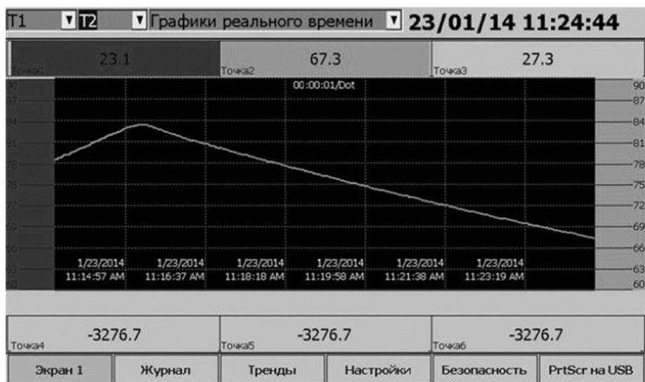
Рисунок 8.3 – График изменения температуры пластины от времени нагрева
