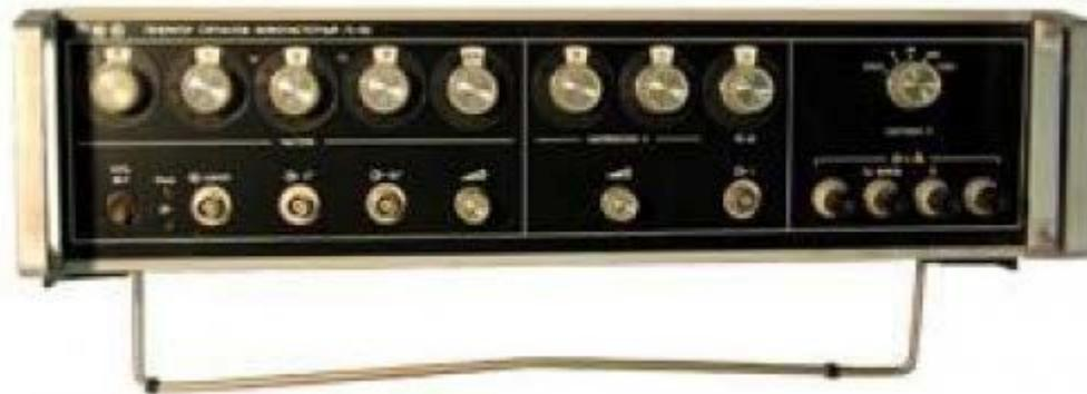
Рисунок 5.3 – Генератор сигналов низкочастотный ГЗ-123
