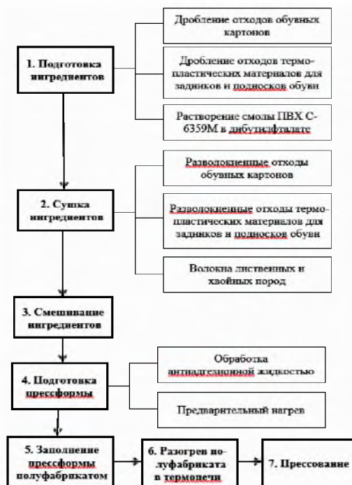
Рисунок 1 – Лабораторная технология получения проб волокнистонаполненных композиционных материалов
