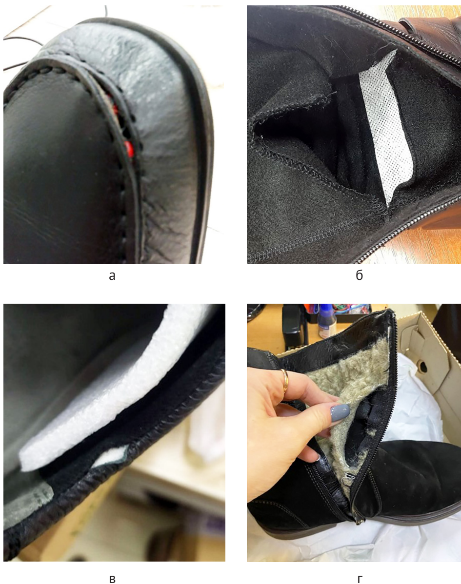
Рисунок 1 – Дефекты ниточных соединений заготовок верха обуви: а – дефект «разрыв строчки»; б – дефект «разрыв материала»; в – дефект «разрыв верхнего канта»; г – дефект «разрыв материала заготовки по строчке»
