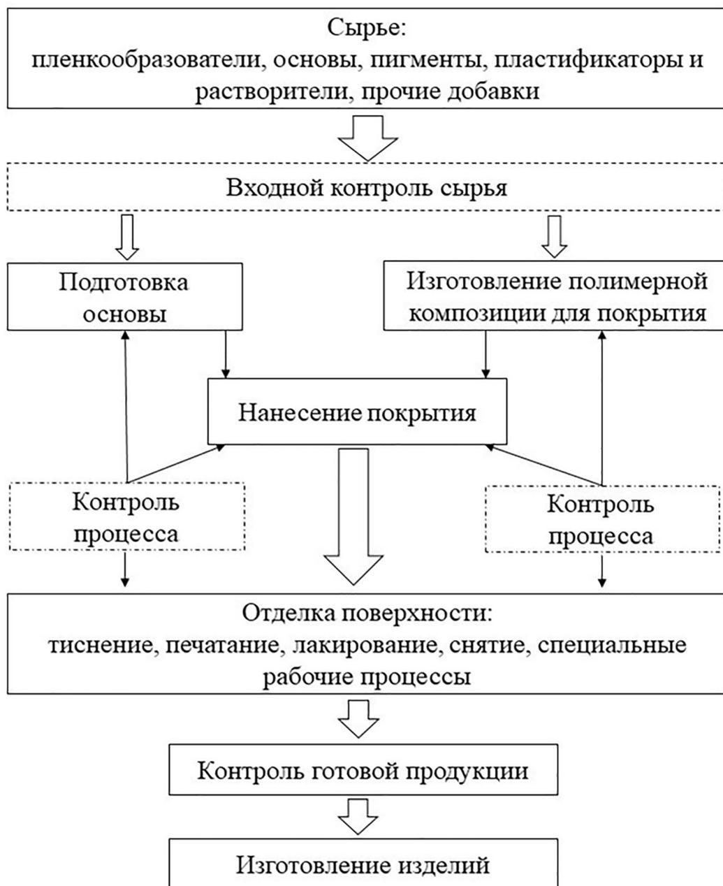
Рисунок 1 – Общая схема технологического процесса производства ИК [9]
