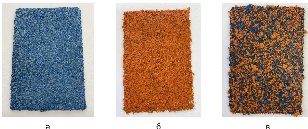
Рисунок 1 – Внешний вид композитов, полученных из отходов полимерно-текстильных материалов: а – образец № 1; б – образец № 2; в – образец № 3
