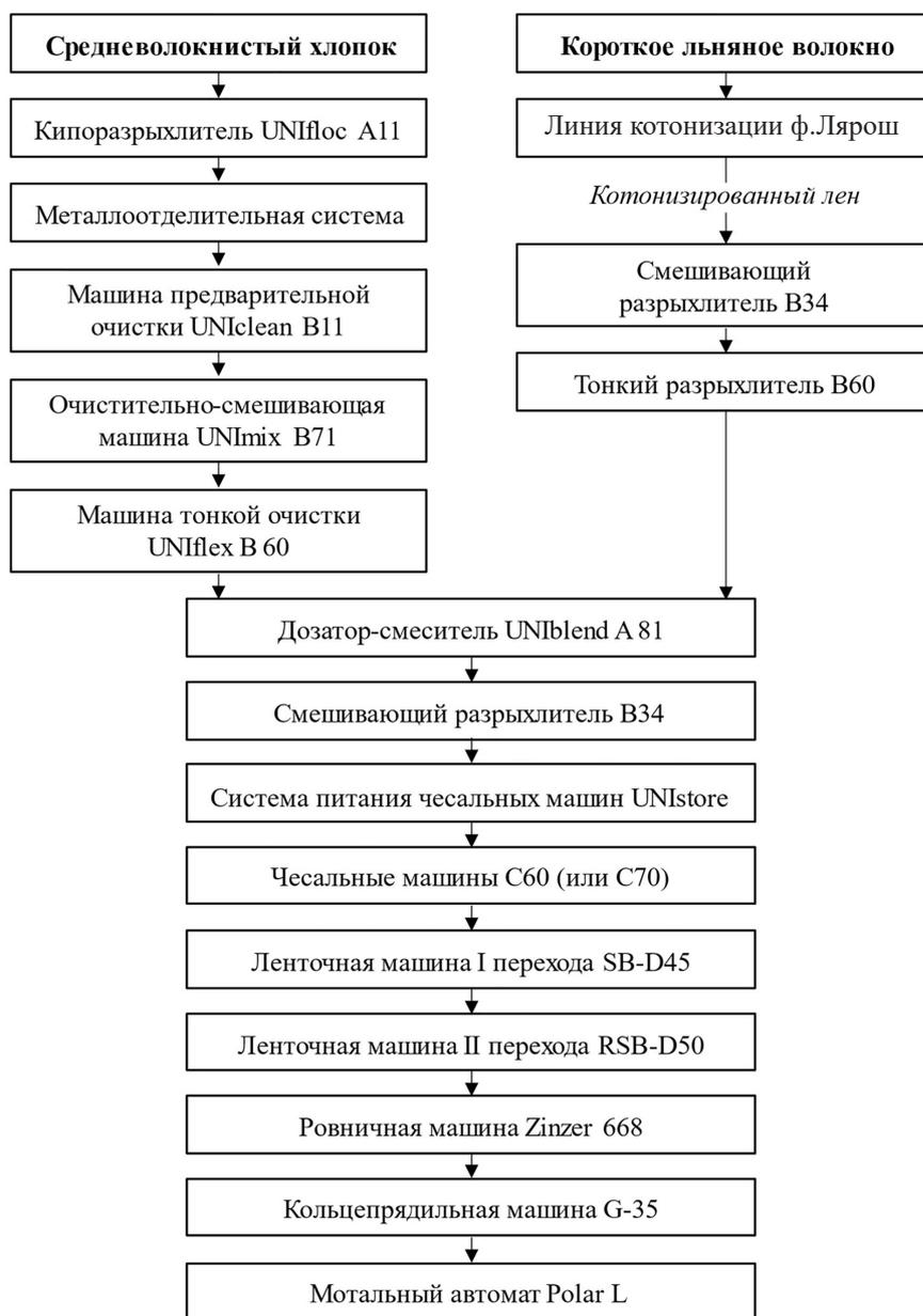
**Рисунок 1 – Схема цепочки технологического оборудования**
