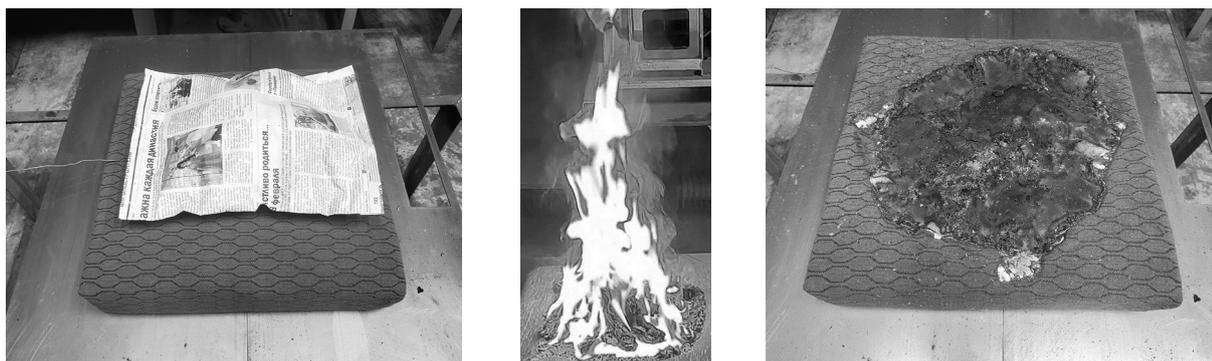
Рисунок 2 – Внешний вид до и после пожарных испытаний элемента мягкой мебели
