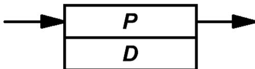
Рисунок 4.1 – Элемент односвязного списка
