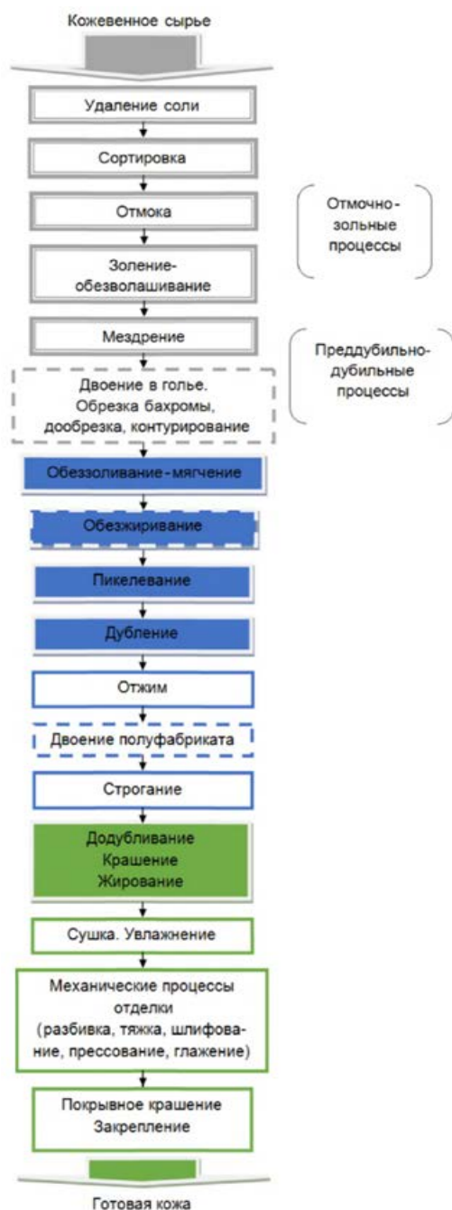
Рисунок 9.1 – Схема технологического процесса производства кож хромового дубления
