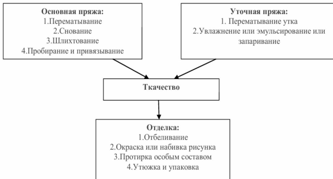
Рисунок 10.2 – Технологический процесс изготовления ткани
