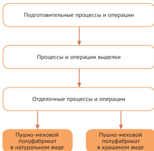
Рисунок 9.2 – Группы технологических процессов и операций производства мехового полуфабриката
