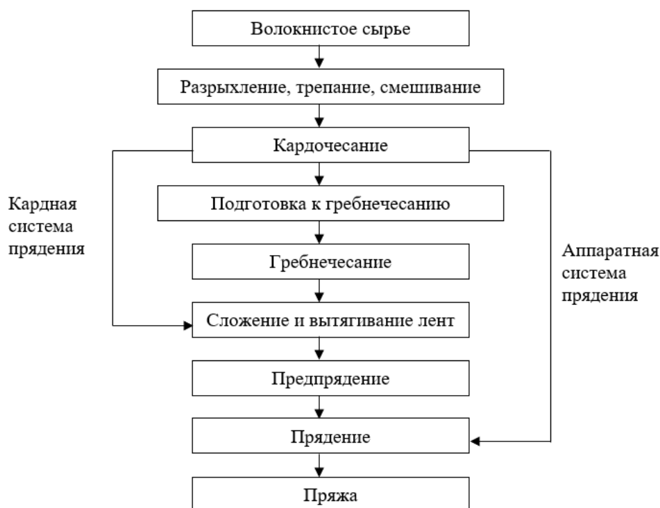
Рисунок 10.1 – Последовательность технологических процессов для разных систем прядения
