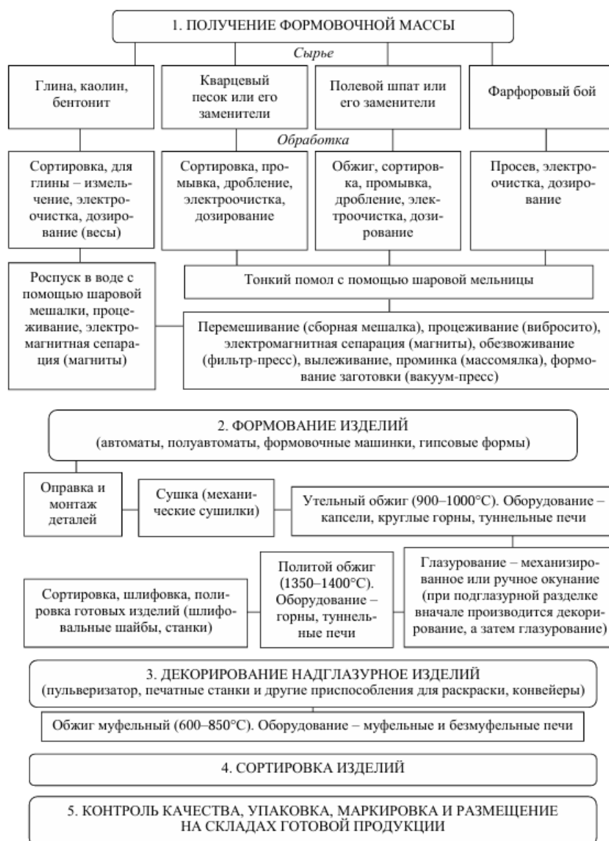
Рисунок 7.1 – Схема производства фарфоровых изделий методом пластического формования
