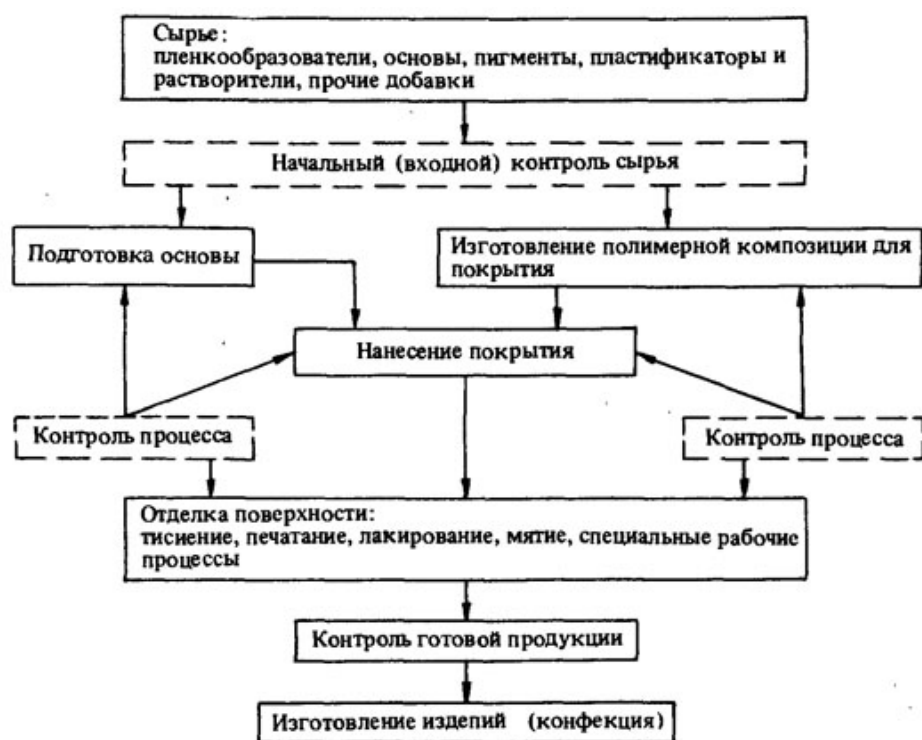
Рисунок 11.1 – Общая схема производства искусственной кожи
