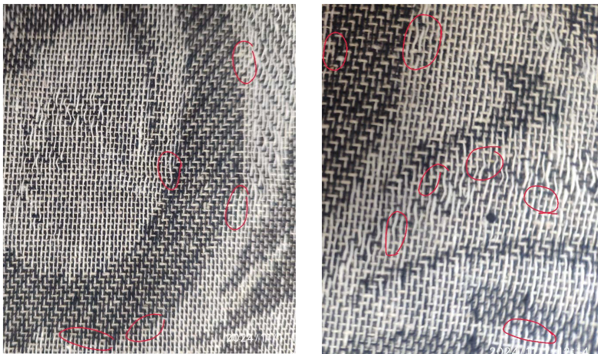
Рисунок 30 – Внешний вид дефектов рисунка, при неправильном проектировании ткани
