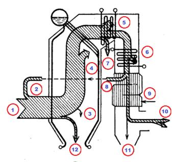
а) располагаемая теплота топлива; б) потери теплоты с наружным охлаждением; в) потери теплоты с уходящими газами; г) часть располагаемой теплоты топлива, воспринимаемая поверхностями пароперегревателя.
