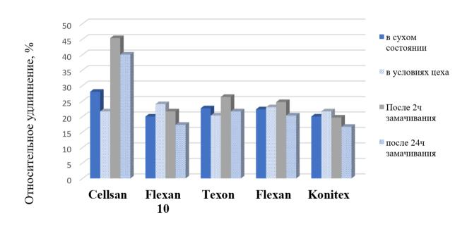
Рисунок 4 – Результаты исследования изменения относительного удлинения при растяжении картонов после увлажнения
