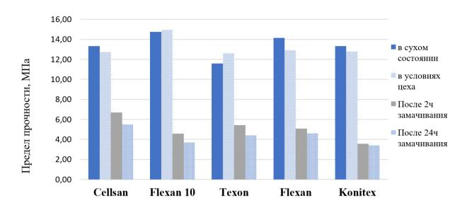
Рисунок 3 – Результаты исследования изменения предела прочности при растяжении картонов после увлажнения
