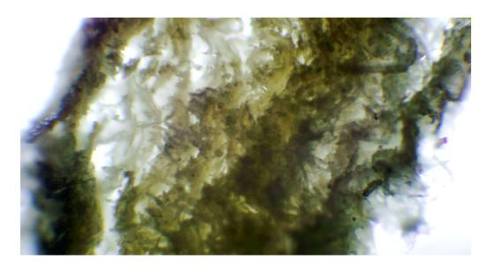
Рисунок 6 – Поперечный срез картона Flexan после выдержки в воде 24 ч (10X/0,25 BD) Figure 6 – Cross section of Flexan cardboard after soaking in water for 24 hours (10X/0.25 BD)
