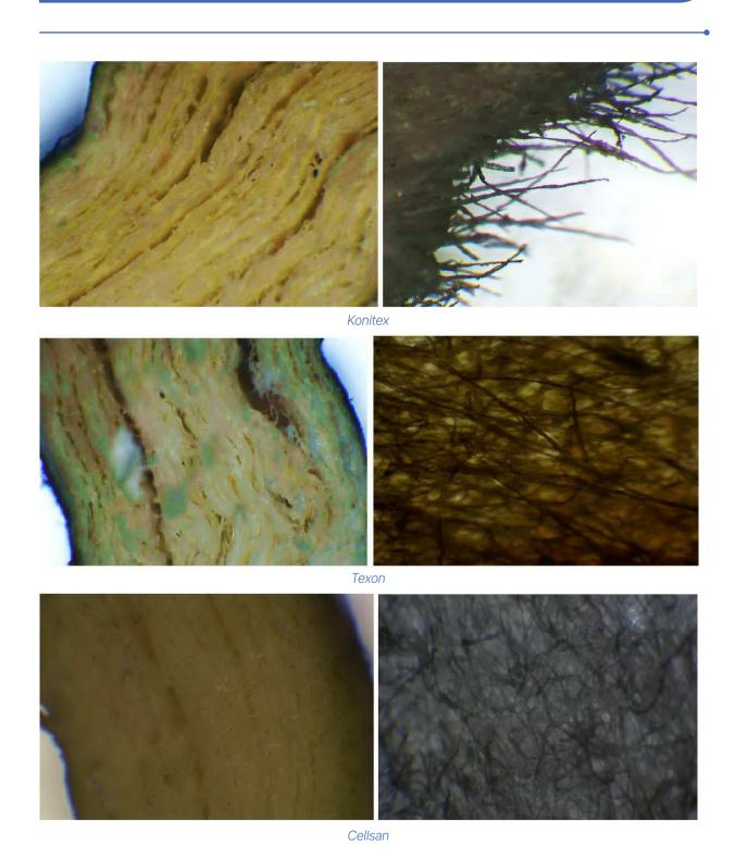
Рисунок 5 – Микроскопические фотографии поперечных срезов картонов на основе целлюлозы (10X/0,25 BD)
