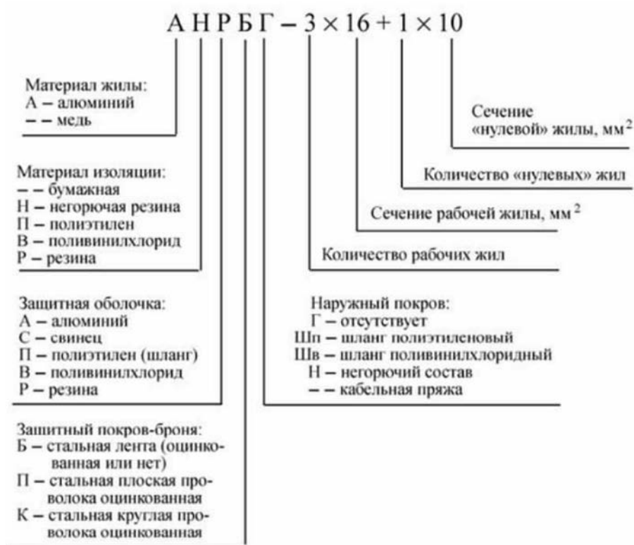
Рисунок 8.1 – Расшифровка маркировки кабеля
