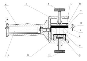
Полезная модель относится к испытательному оборудованию, обеспечивающему оценку водозащитных свойств материалов.
