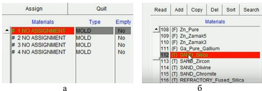
Рисунок 4.42 – Выбор материалов отливки и формы
