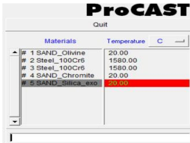
Рисунок 4.48 – Вкладка ввода температуры доменов формы
