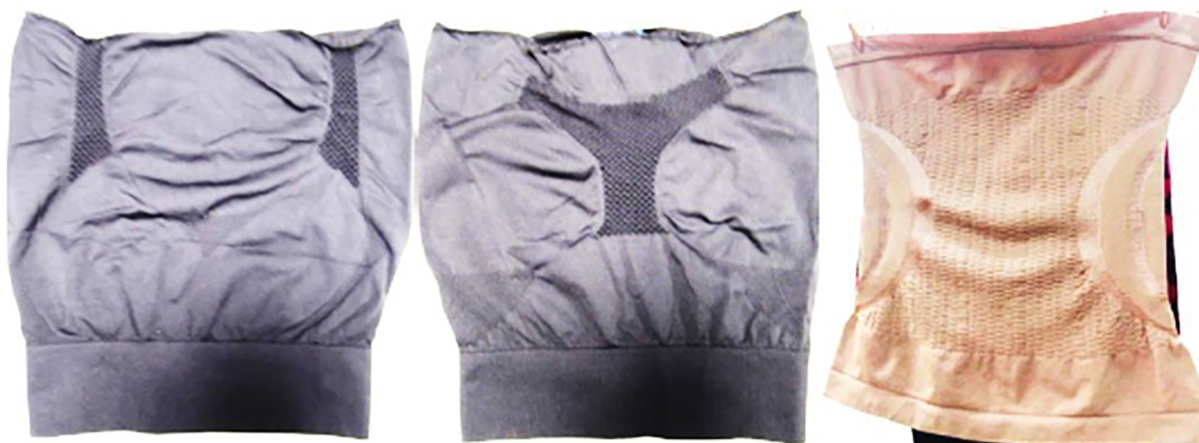
Рисунок 2 – Использование разного типа переплетения в определенных зонах
