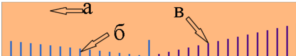
Рисунок 15 – Сокращенный патрон с расположением элементов, отличающихся по количеству пересечений нитей основы нитями утка
