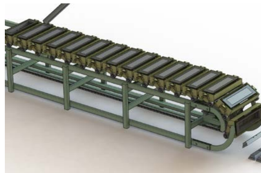
Рисунок 3.3 – Лента конвейерного потока с люльками
