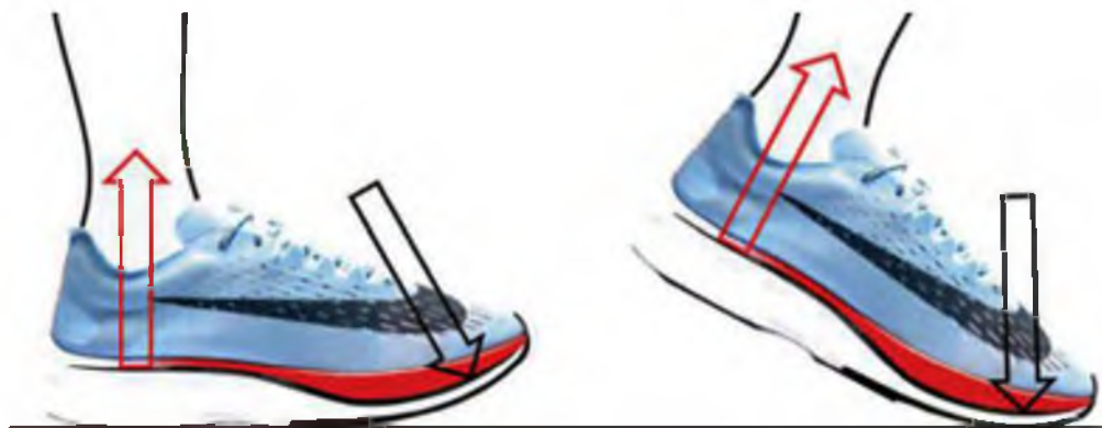
Рисунок 4 – Эффект «качелей» в беговых кроссовках с карбоновой пластиной
